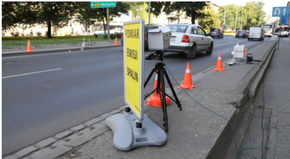
Rysunek 10. Urządzenia teledetekcyjne do pomiaru emisji spalin z pojazdów drogowych 50
